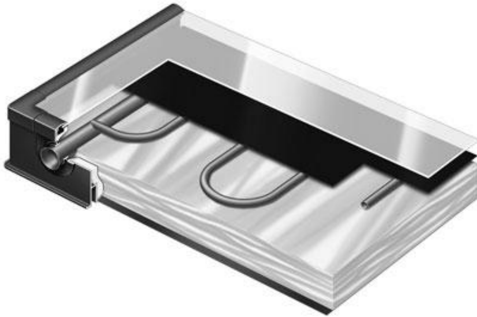
Рисунок 4 – Будова плоского сонячного колектора
