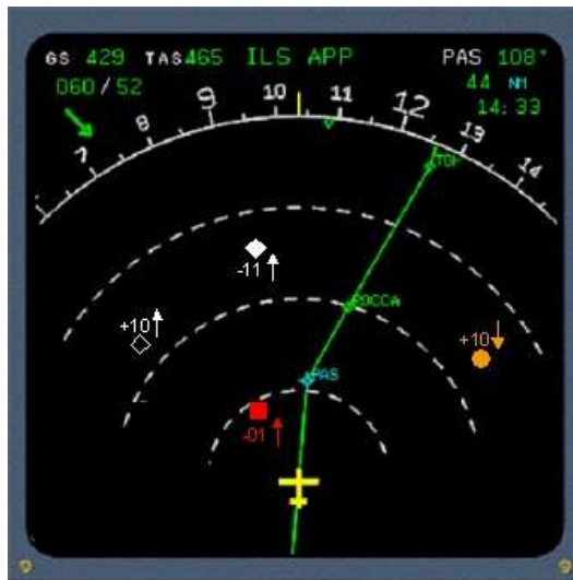
Рисунок 6. Індикатор TCAS, вмонтований у навігаційний дисплей Airbus
