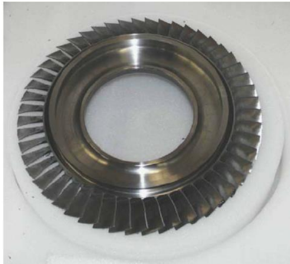
Рис. 4 - Моноколесо (Бліск) осевого компресора
