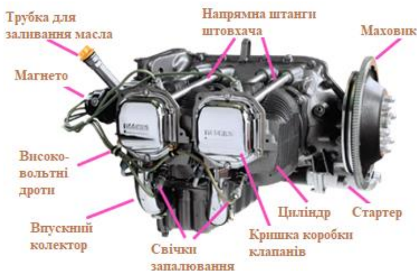
Рис.12. Чотирициліндровий опозитний двигун Двигун Lyscoming від 100 до 300 к.с
