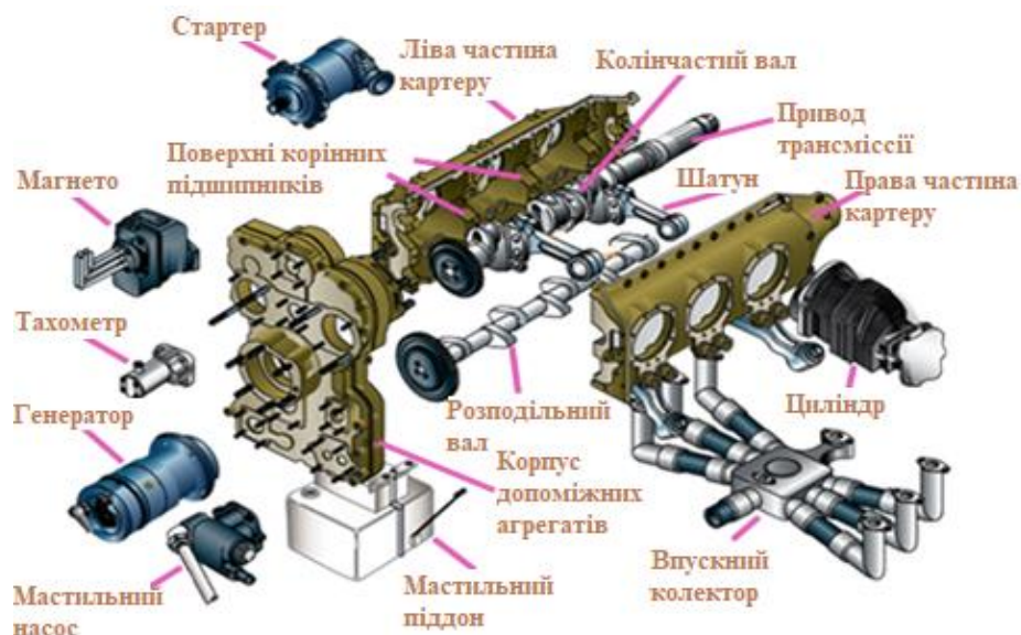
Рис.13. Схема 6-циліндрового плоского двигуна
