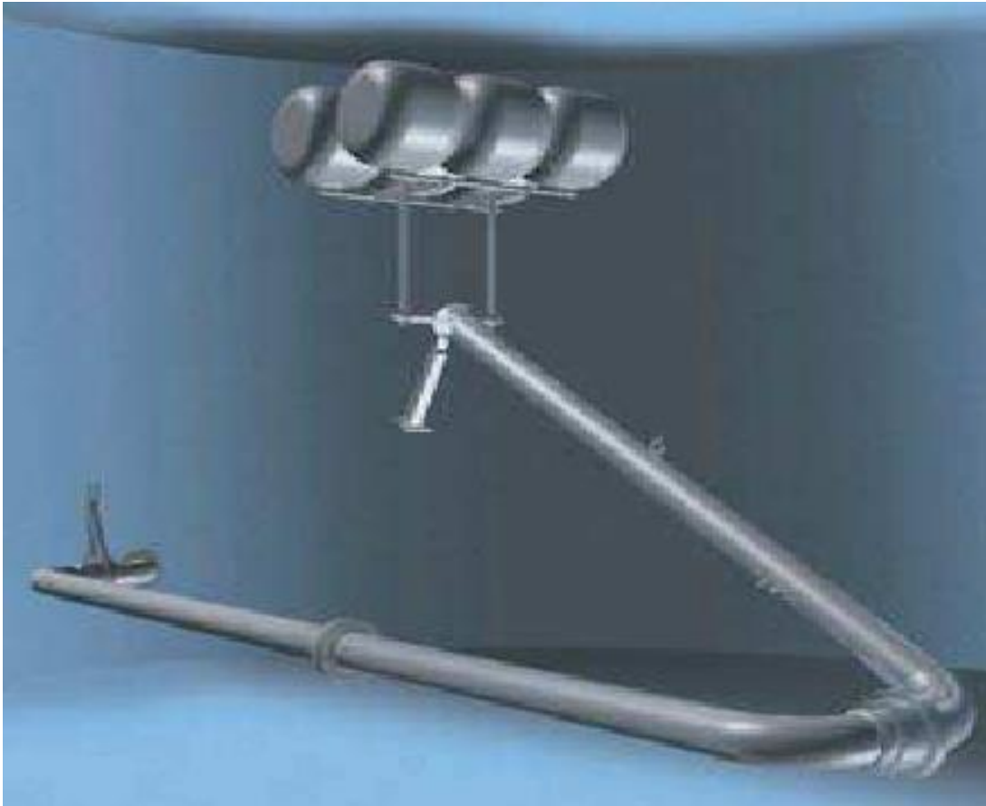
Рис. 12. Плаваючий пристрій для верхнього забору палива
