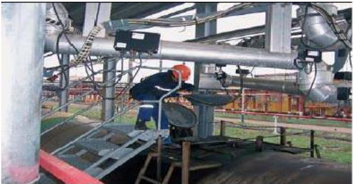
Рис. 37 Налив під днище ж / д цистерн 41
