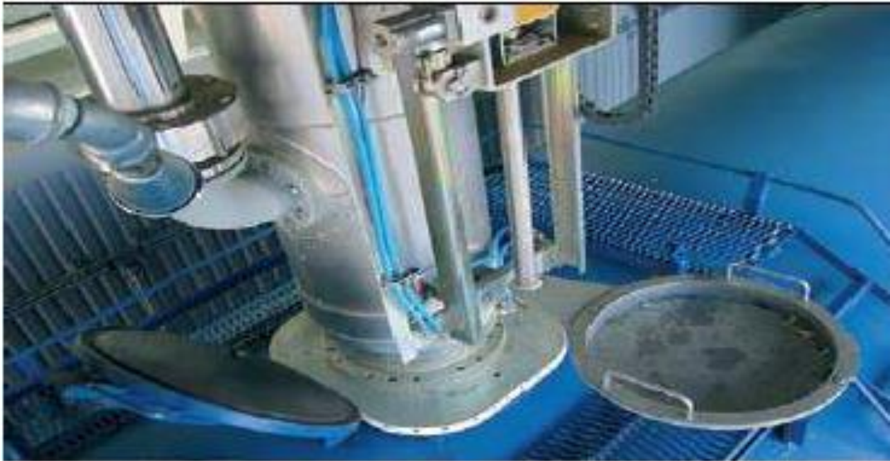
Рис. 38 Наливна труба з системою відведення парів
