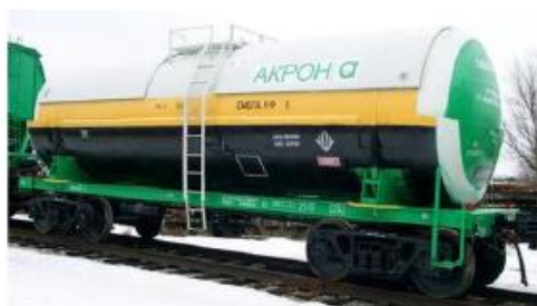
Рис. 7. - Залізнична цистерна з паровою сорочкою
