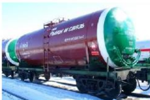
Рис. 8 Залізнична цистерна зі стаціонарним теплообмінником
