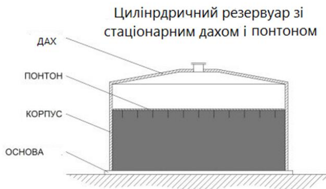
Рис. 4 – Циліндричний резервуар зі стаціонарним дахом і понтоном
