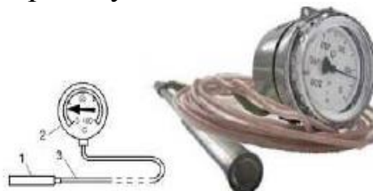
Рисунок 3– Газовий манометричний термометр 1– термобалон , 2 – манометр, 3 – капіляр
