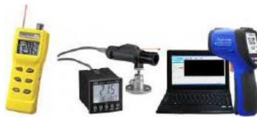
Рисунок 9 – Пірометри випромінювання
