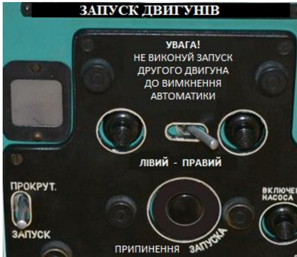
Рис.2 Щиток управління и контролю роботи системи запуску
