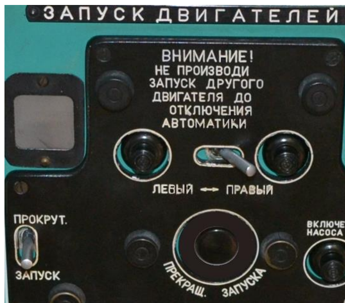
Рис.2 Щиток управління и контролю роботи системи запуску
