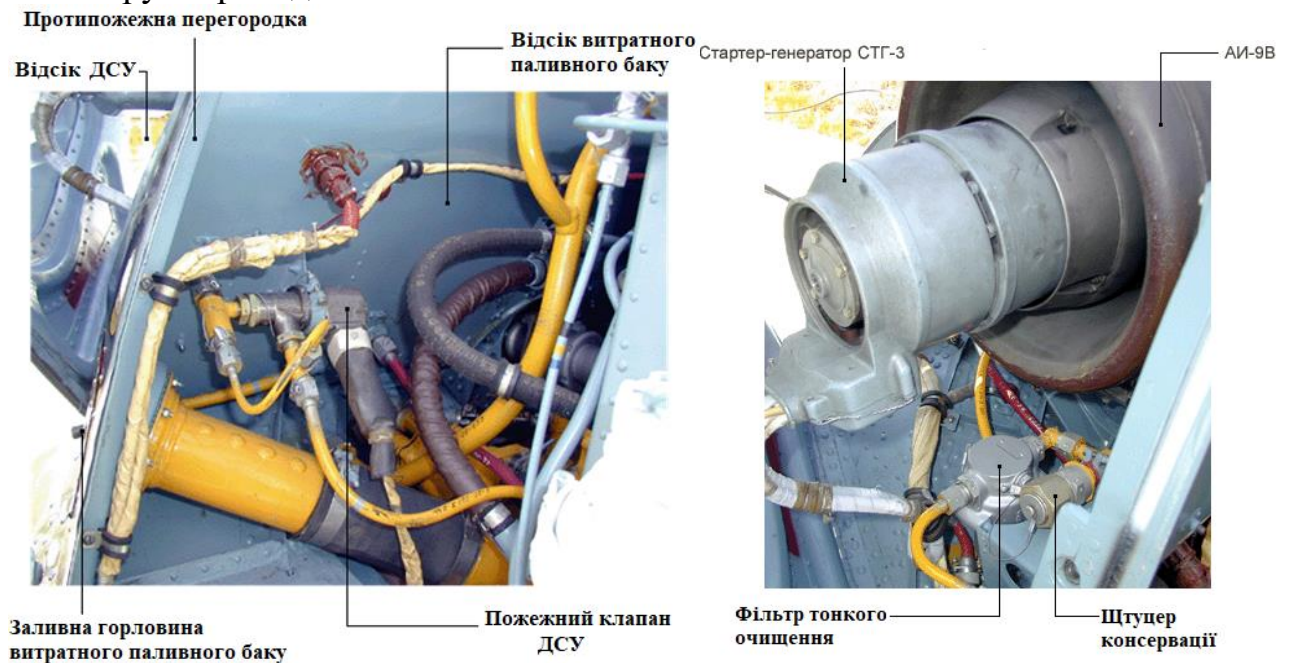
Рис. 5 Розташування агрегатів паливної системи двигуна
