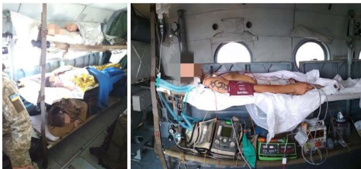
Рисунок 2. Гвинтокрил Мі-8. Способи транспортування поранених лежачи. Варіант розміщення трьох лежачих пацієнтів (зліва) та одного важкохворого із високою залежністю від медичного супроводу (праворуч).
