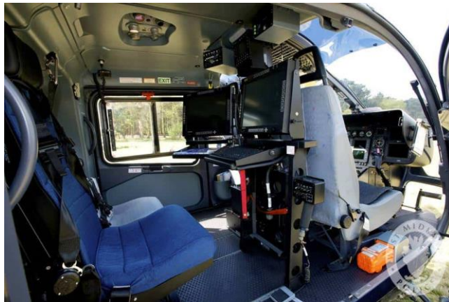
Станція радіооператора в поліцейському вертольоті EC135
