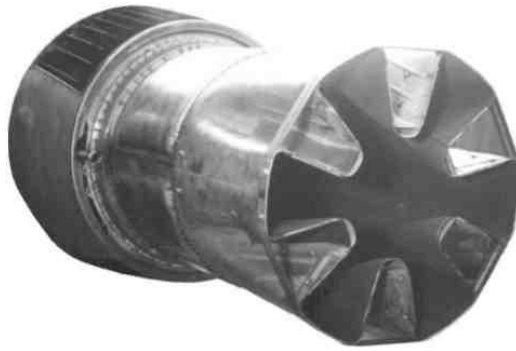
Рис. 8 Експериментальне шумоглушне сопло
