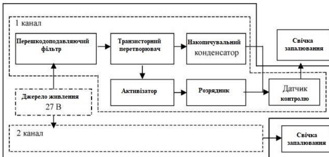
Рис. 7 Функціональна схема системи запалювання
