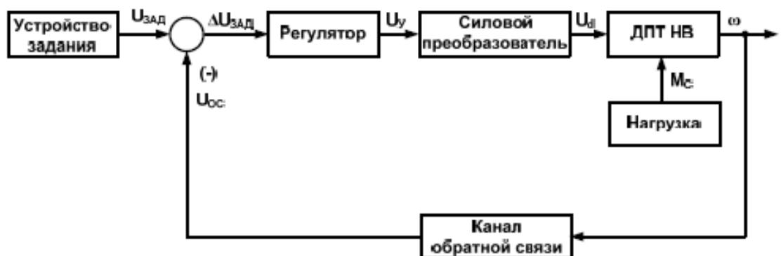
Рис. 1. Система автоматичного регулювання швидкості двигуна постійного струму незалежного збудження (ДПТ НВ)
