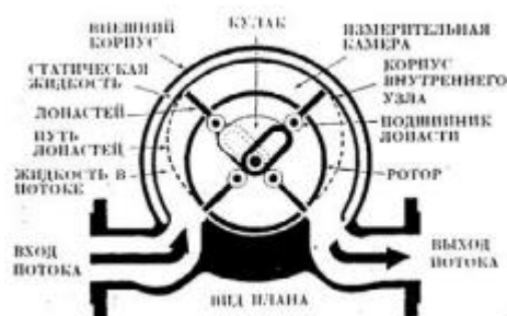
Рис. 3 - Принципова схема лопатевих лічильників рідини
