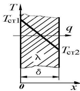
А щільність теплового потоку через плоску многослойну стінку пропорційна сумарному температурному напору (різниці температур на зовнішніх поверхнях стінки) і обернено пропорційна повного тепловому опору стінки, рівному сумі теплових опорів її окремих шарів.
