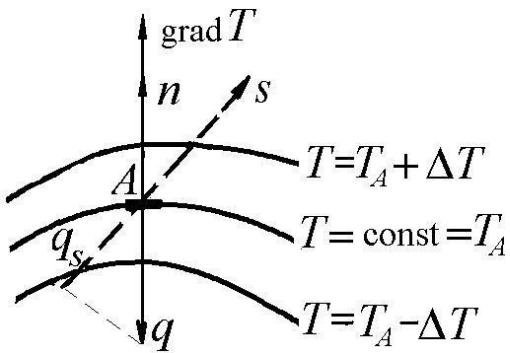
Градієнт температури є віктором, спрямованим по нормальні до ізотермічної поверхні в бік збільшення температури.
