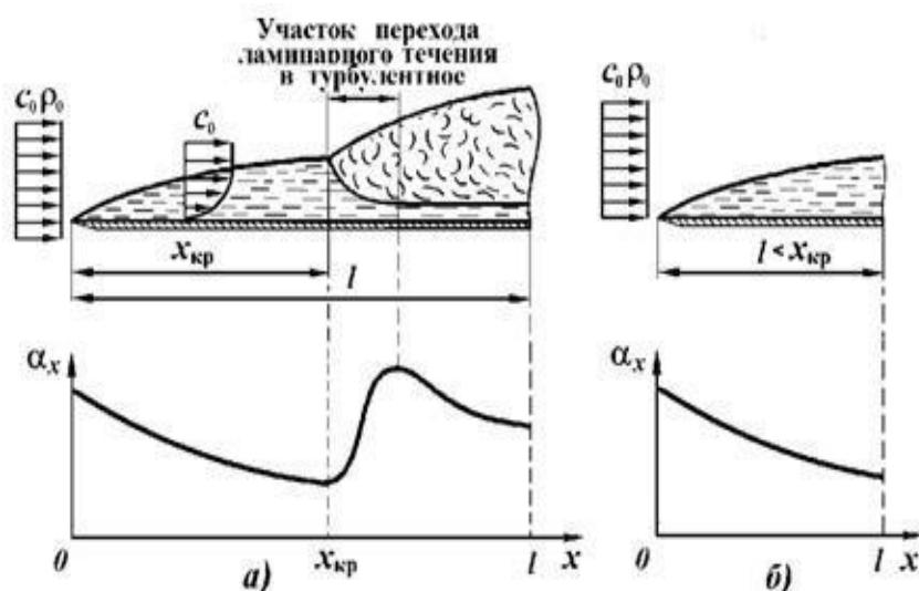
**Положення точки переходу ламінарного режиму течії в турбулентний залежить від швидкості, щільності і в'язкості набегаючих на пластину потоку, а також від рівня турбулентності в набігає потоці.**
