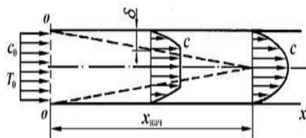
Якщо стінки каналів мають помітну шорсткість (висота горбків більше товщини ламінарного підшару) або забезпечені спеціальними турбулізаторами, то інтенсивність тепловіддачі буде вищою, що враховується за допомогою спеціальних поправочних коефіцієнтів.
