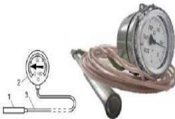
1 – термобалон, 2 – манометр, 3 – капіляр Рисунок 14 – Газовий манометричний термометр
