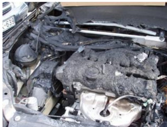
Рис. 8 – Наслідок перегрівання деталей машин (двигун автомобіля)
