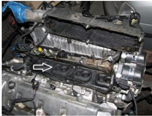
Рис. 9 – Нагар на впускному колекторі (складається із мастила та частиноксажі)
