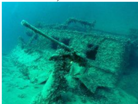
Рис. 11 – Приклад дії моллюсків на занурені у воду деталі машин
