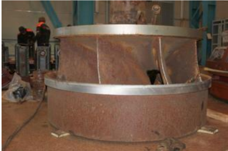
Рис. 2 – Корозійне руйнування поверхні робочого колеса турбіни ГЕС
