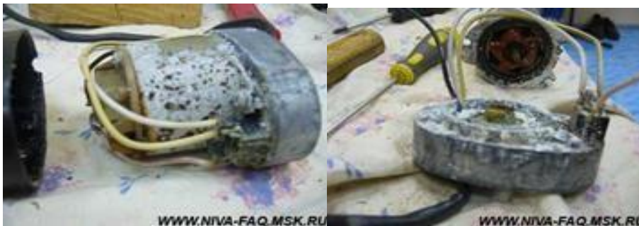
Рис. 10 – Пліснява на моторі-редукторі очисника фар автомобіля Крім того, шкоди завдають моллюски та гризуни (миші та пацюки, рис. 11).
