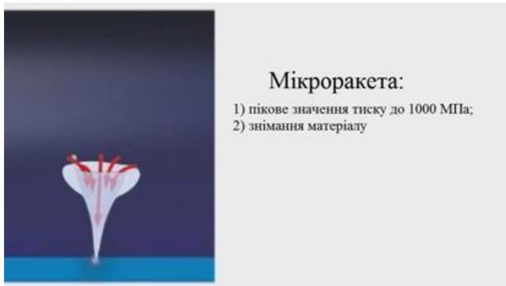
Рис. 6 – Принцип дії кавітації на поверхні обладнання
