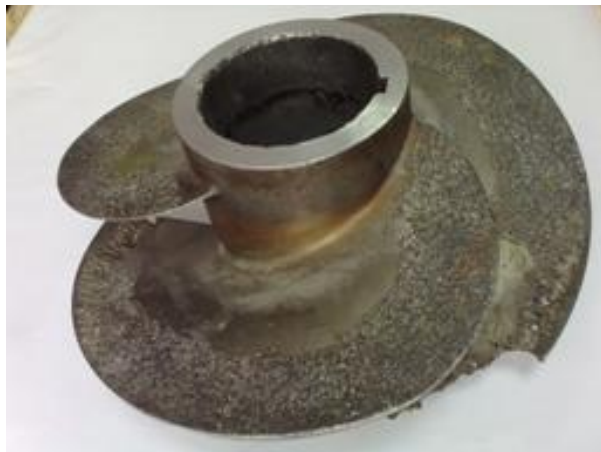
Рис. 2 – Кавітаційне зношення робочого колеса
