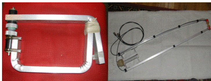
Рис. 2.6. Перетворювачі та безлюфтові оправлення для тіньового методу контролю
