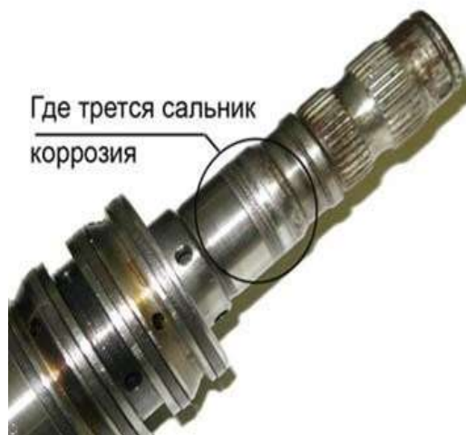
Рисунок 7 – Корозія при терті
