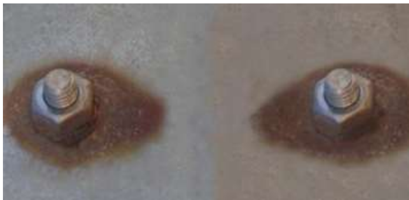
Рисунок 3 – Контактна корозія
