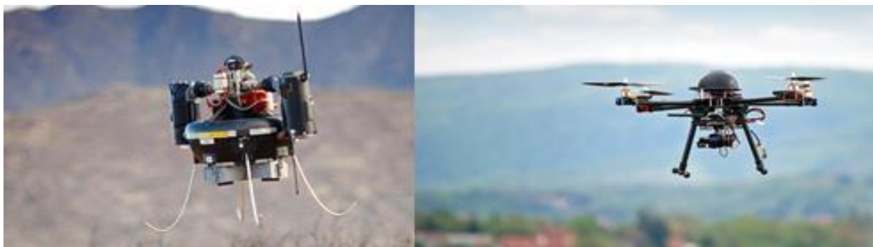
Рисунок 4 – Повітряна розвідка за допомогою БПЛА: а) з апаратурою радіаційної розвідки; б) з апаратурою хімічної розвідки
