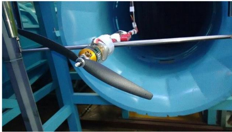
Рис.4 – Експеримент для отримання аеродинамічних властивостей повітряних гвинтів Опис технічної бази
