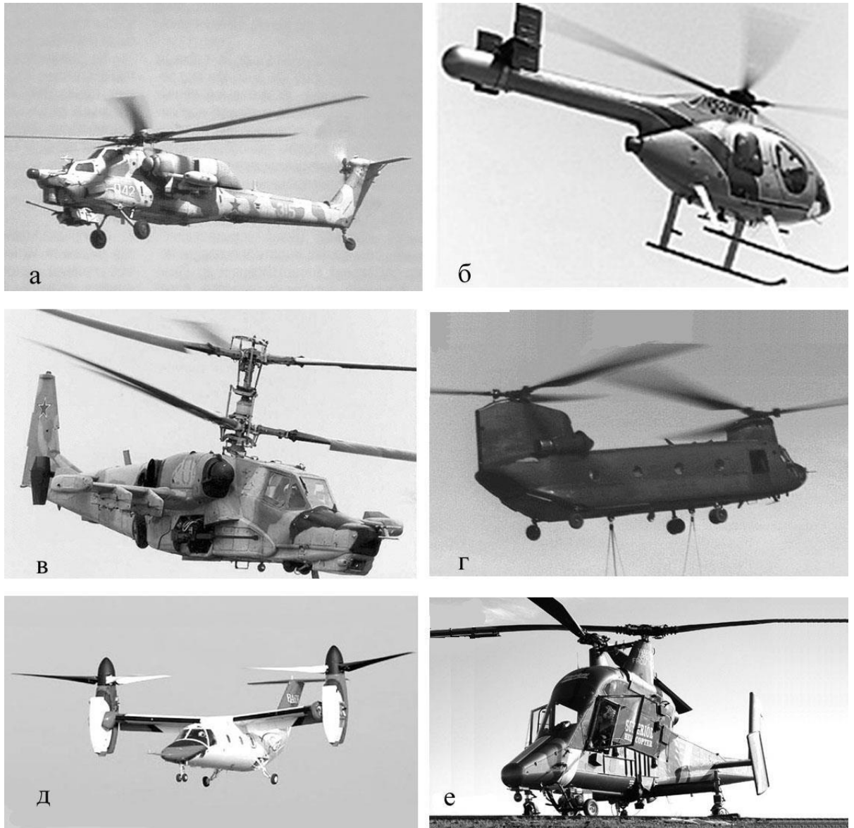
Малюнок 1. Різні схеми розташування несучих гвинтів.
