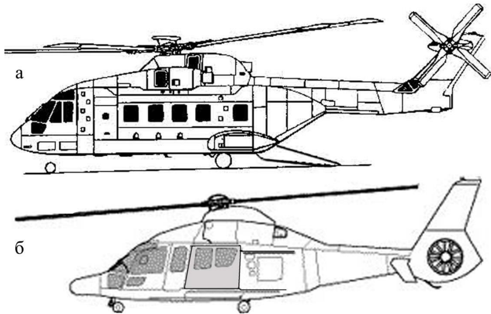
Рис. 2.3. Вертоліт з відкритим вантажним трапом (а) і зі зсувними бічними дверми транспортного відсіку (б).
