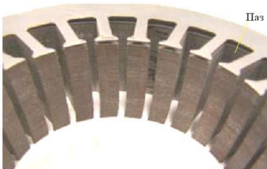
Рис. 5 Магнітопровід статора двигуна змінного струму
