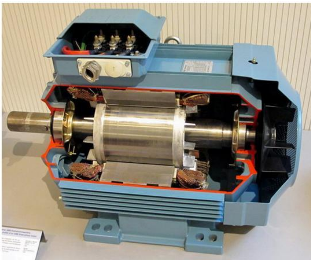
Рис. 11 Асинхронний двигун (розрізано)
