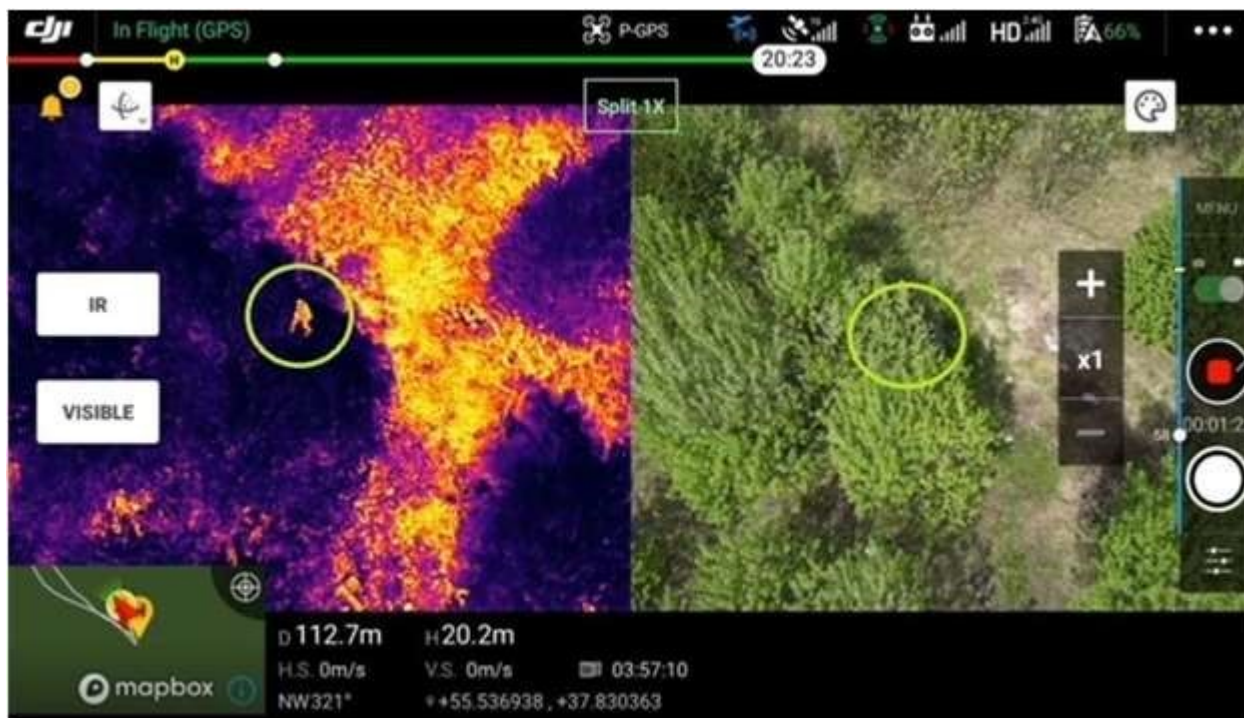
Рисунок 2. Виявлення постраждалого за допомогою тепловізора
