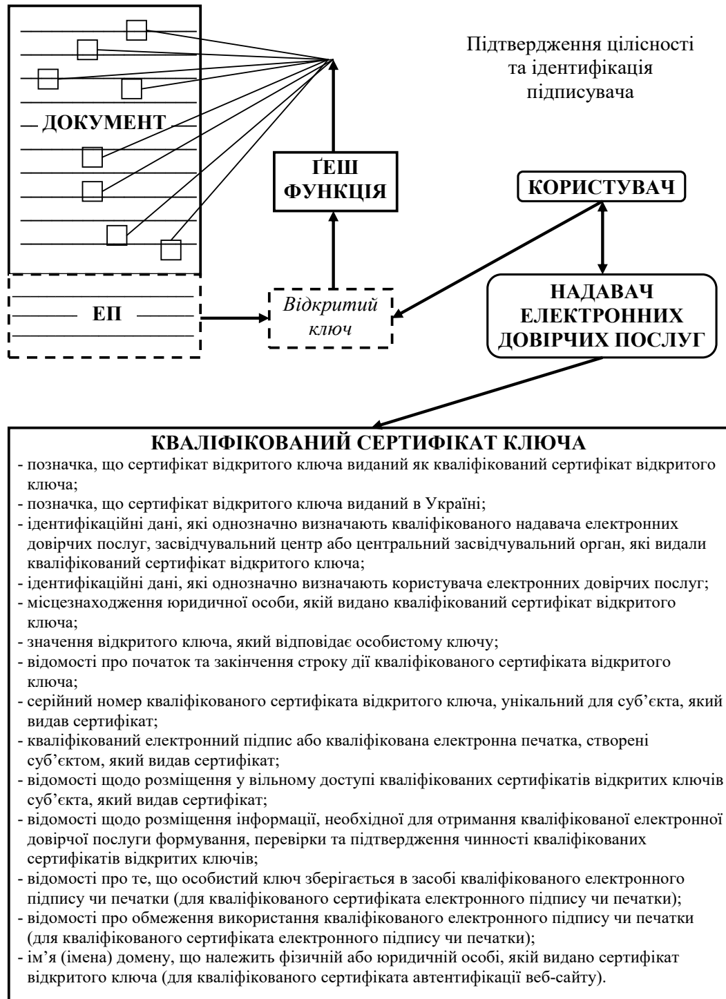
Рис. 2. Приблизна модель перевірки електронного підпису
