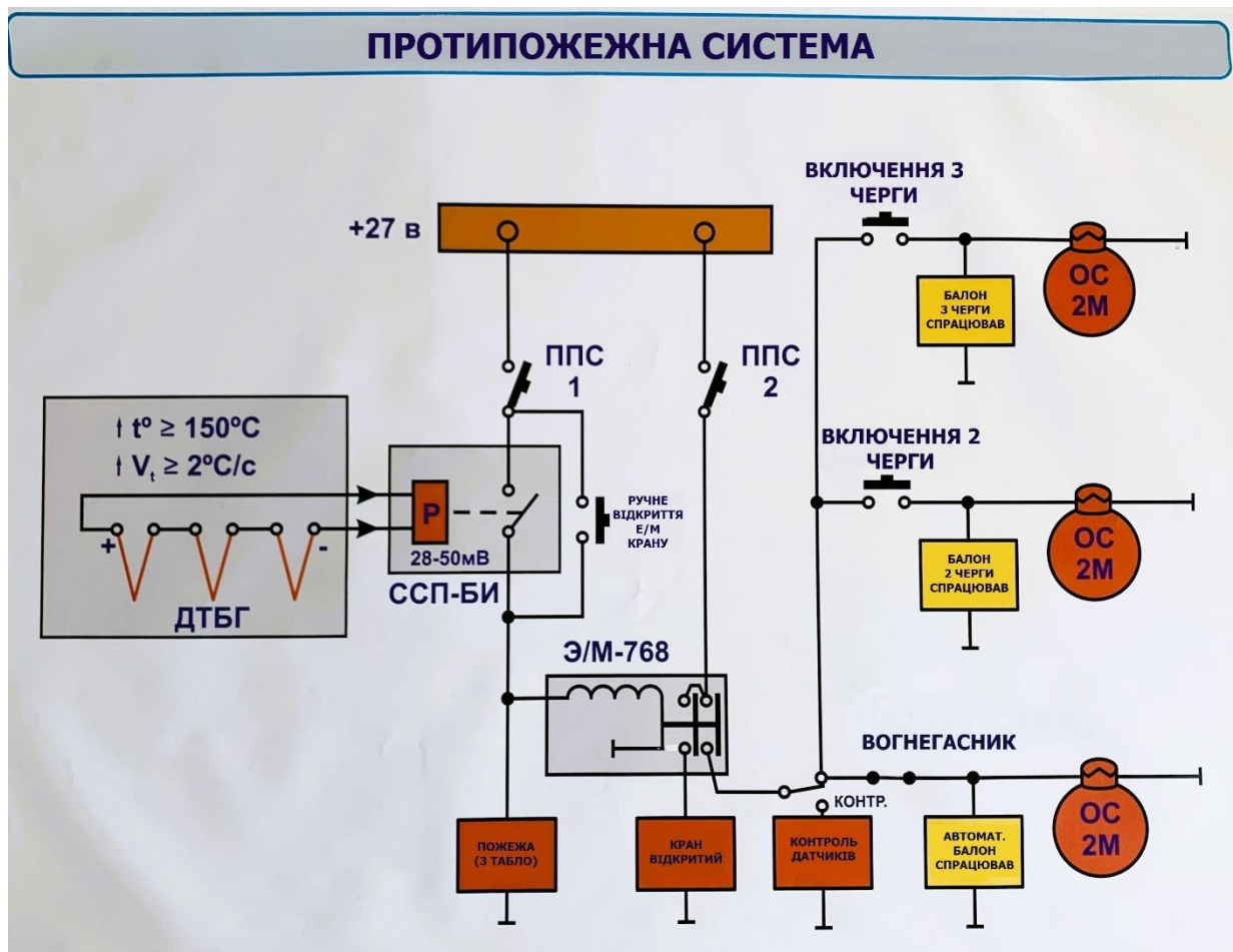
Рисунок - Схема роботи протипожежної системи
