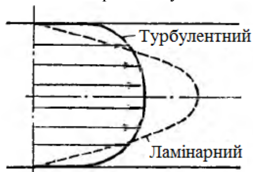
Рисунок 1.56 – Епюри швидкостей течії рідини у ламинарному і турбулентному потоках
