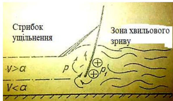
Рис 3.1.27 Схема виникнення хвильового відриву в примежовому шарі
