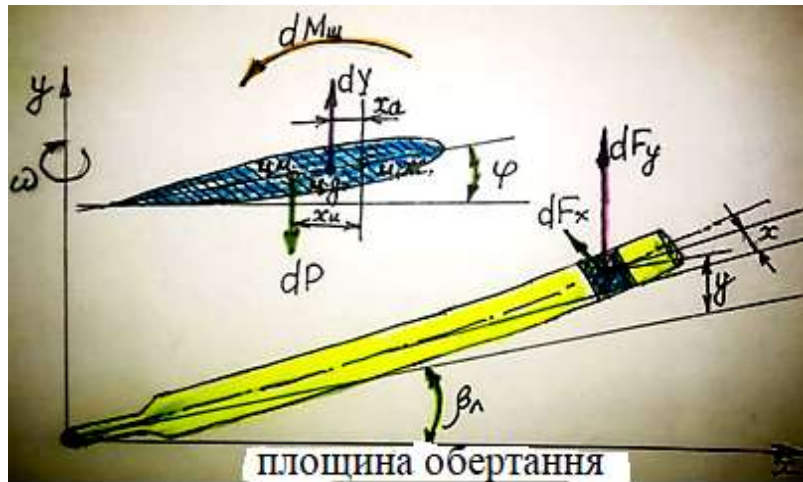
Рис 5.1.9 Схема сил і моментів діючих на елемент лопаті
