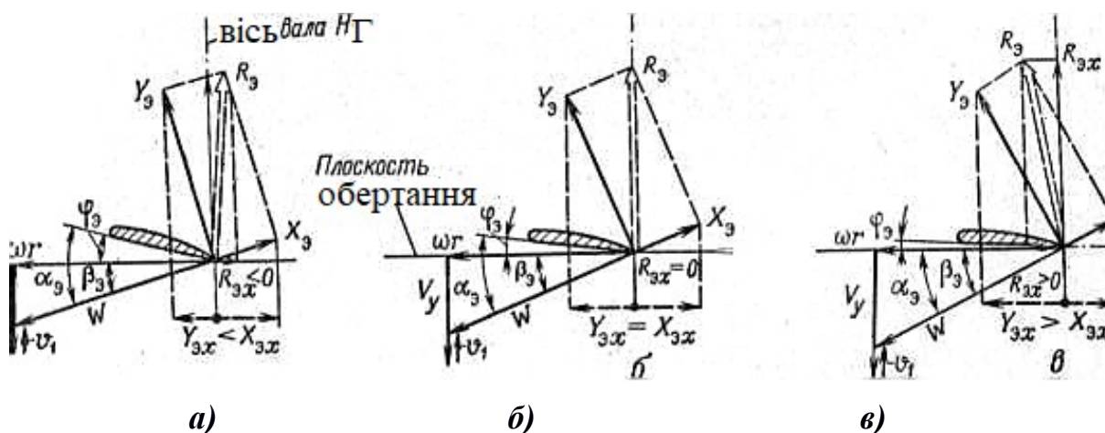
Рис 7.15. Трикутники швидкостей в характерному перерізі лопаті і умови уповільненої (а), сталої (б) і прискореного (в) самообертання НГ при вертикальному зниженні
