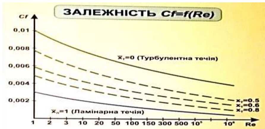
Рис 5.2.2 Графічна залежність коефіцієнта тертя C_f від числа Рейнольдса Re
