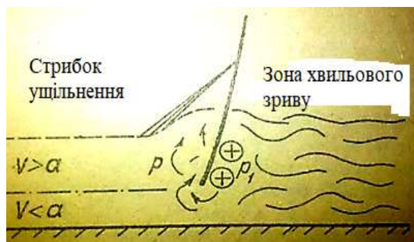
Рис 5.3.7 Схема зміни параметрів повітряного потоку на стрибку ущільнення в примежовому шарі
