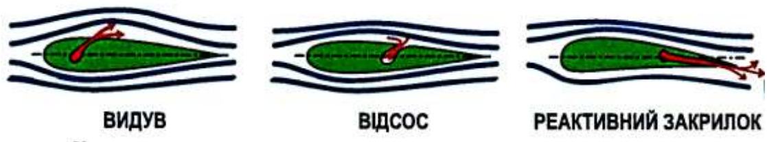
Рис 5.3.6 Схема керування швидкістю течії в примежовому шарі.
