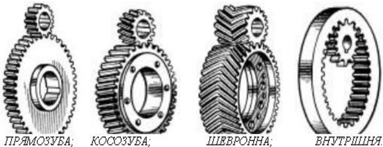
Рис.2.1 Типи циліндричних передач
