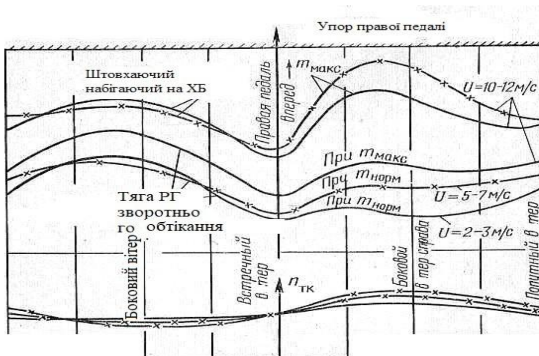
Рис 7.11 Вплив вітру на балансування вертольота на висінні
