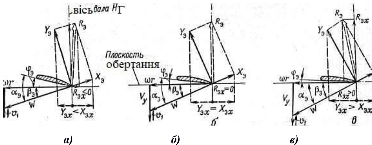
Рис 7.15. Трикутники швидкостей в характерному перерізі лопаті і умови уповільненої (а), сталого (б) і прискореного (в) самообертання НГ при вертикальному зниженні
