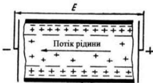
Рисунок 7 – Утворення подвійного електричного шару і рух рідини під впливом електричного поля
