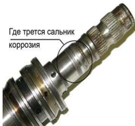
Рисунок 7 – Корозія при терті
