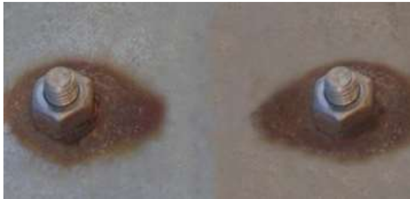
Рисунок 3 – Контактна корозія
