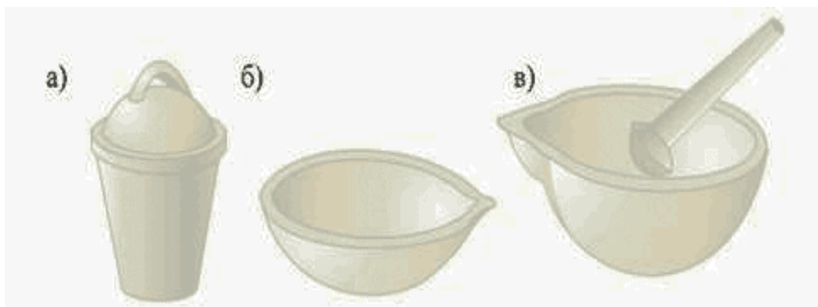
Рисунок 8 – Фарфоровий посуд: а) тигель; б) чашка для випаровування; в) ступка з товкачиком
