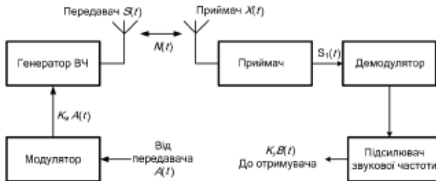
Рисунок 3- Структурна схема каналу радіозв'язку.
