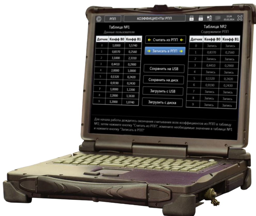
Рисунок 3 - Виносний термінал бортової системи технічного обслуговування.
