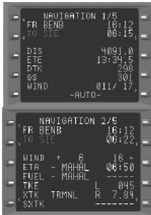
Рисунок 5 - Приклад відображення інформації на MCDU
