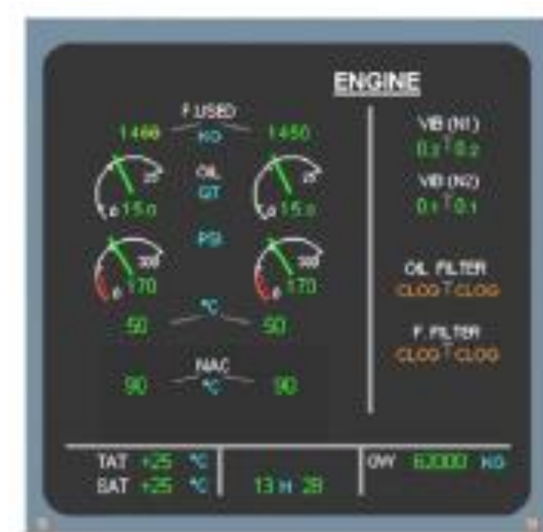
Рисунок 9 – Відображення параметрів роботи силової установки на ECAM
